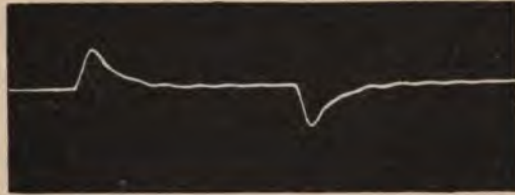
Abb. 262. Oszillographische Aufnahme des Stromes einer aperiodischen Entladung und darauffolgender Ladung.
